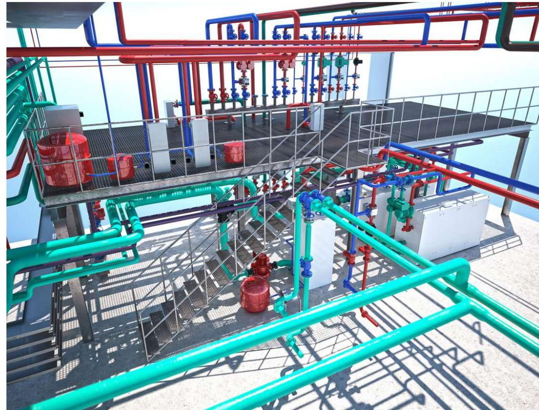
Auszug BIM-Modell KA-LEV Abwasserwärmepumpen
